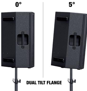
Los altavoces disponen de un vaso de montaje en soporte con un ángulo a 0° (posición posterior) y otro a 5° (posición anterior). Ejemplo de aplicación: Utilice el adaptador de soporte a 0° para el refuerzo sonoro de eventos con público de pie, y el adaptador de soporte a un ángulo de 5° si el público está sentado.
