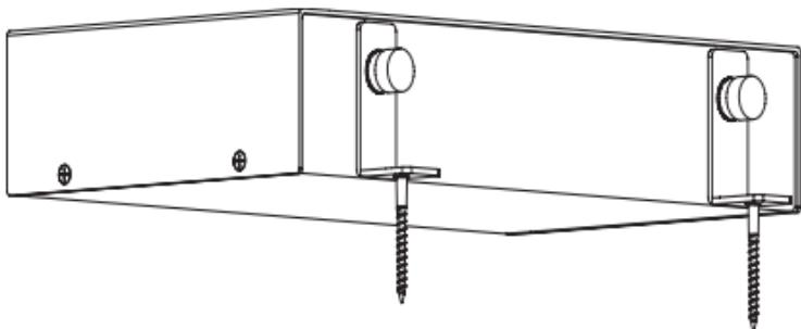
Los herrajes pueden colocarse en una posición hacia afuera o hacia adentro como se muestra, para permitir diferentes tipos de instalación.
