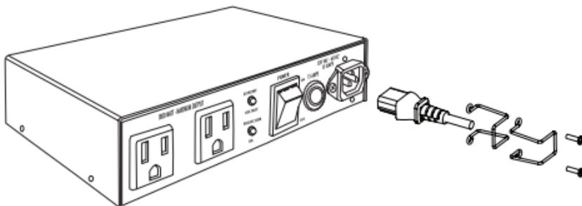
Pour attacher ou détacher la bride de sécurité de corde de courant alternatif, Simplement réunissez ou démontez suivant les indications de l'illustration ci-dessus. Placez la bride ensemble comme montré, et fixez les vis dans les trous fournis pour fermer à clef le cordon de secteur en place. Desserrez les vis et enlevez la bride à partir de l'unité pour détacher.
